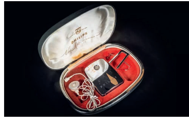
Taschenhörgerät mit Transistoren (ab 1954) (Bild: AfH)
