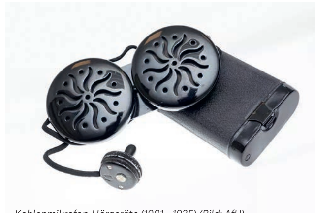
Kohlenmikrofon-Hörgeräte (1901 - 1935) (Bild: AfH)
