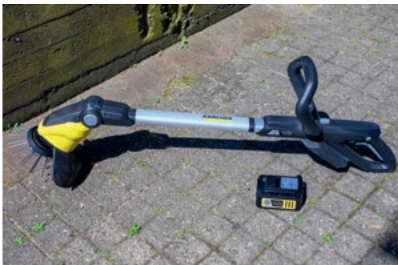
Rasentrimmer mit Akku der Fa. Kärcher, Typ „WRD 18-55“
